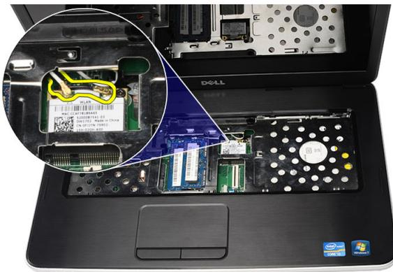
4. Sollevare il dispositivo di chiusura per sbloccare la scheda WLAN dall'alloggiamento.
